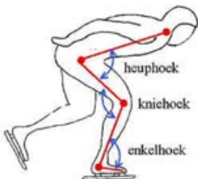
Fig. 1. Zijaanzicht schaatser met prestatie-bepalende gewrichtshoeken
