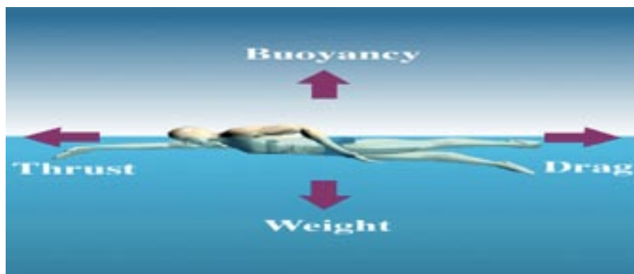
Figuur 1. Free body diagram met de krachten die werken op een zwemmer die zwemt met een constante zwemsnelheid. De verschillende krachten die onderscheiden kunnen worden zijn weerstandskracht (drag), propulsiekracht (thrust), zwaartekracht (weight) en liftkracht (buoyancy).
